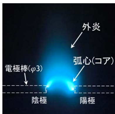
図 17 PV パネルを電源とした直流アークの発生
