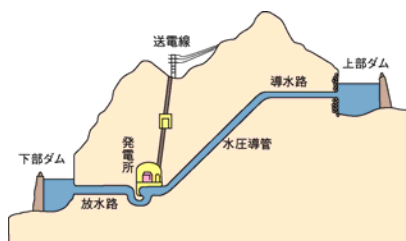
図 27 揚水発電所の概要
