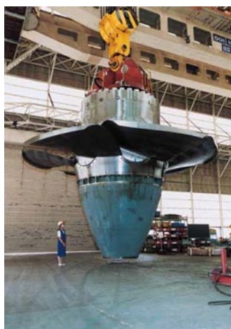
図 12 水車 (235MW) (画像提供：日立三菱水力㈱)
