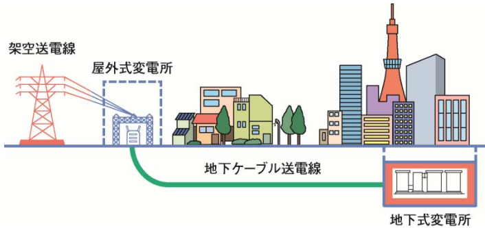
図 29 屋外式変電所と地下式変電所
