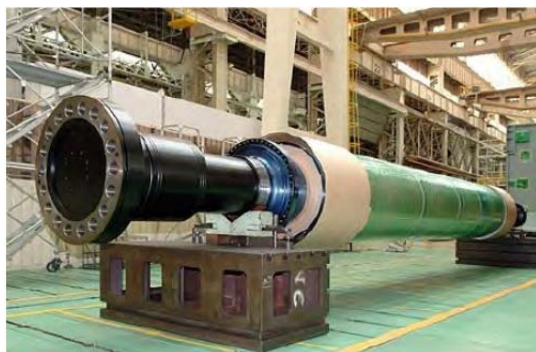
図 40 タービン発電機の回転子例
