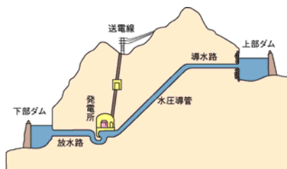
図 27 揚水発電所の概要
