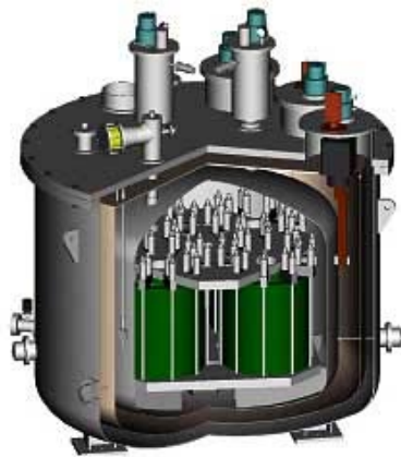
図 30 5,000kW・1秒補償級 超電導電力貯蔵装置 (出典：中部電力株式会社 HP プレスリリースバックナンバー 「超電導電力貯蔵システム SMES のフィールド試験の実施について」)
