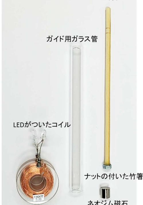
図1. ストンピカの構成部品
