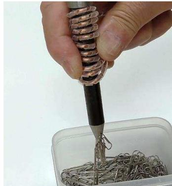
図7 フレキコイルを用いた電磁石
