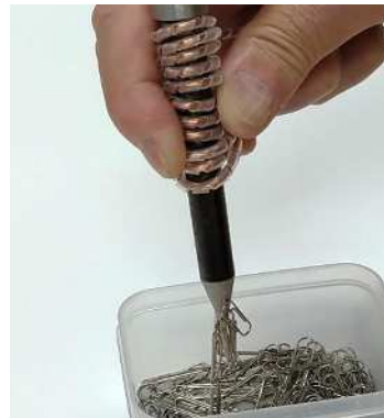
図7 フレキコイルを用いた電磁石
