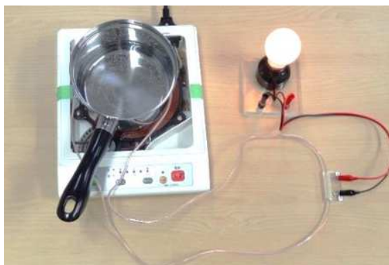
図10 IH 調理器を用いた電磁誘導の実験
